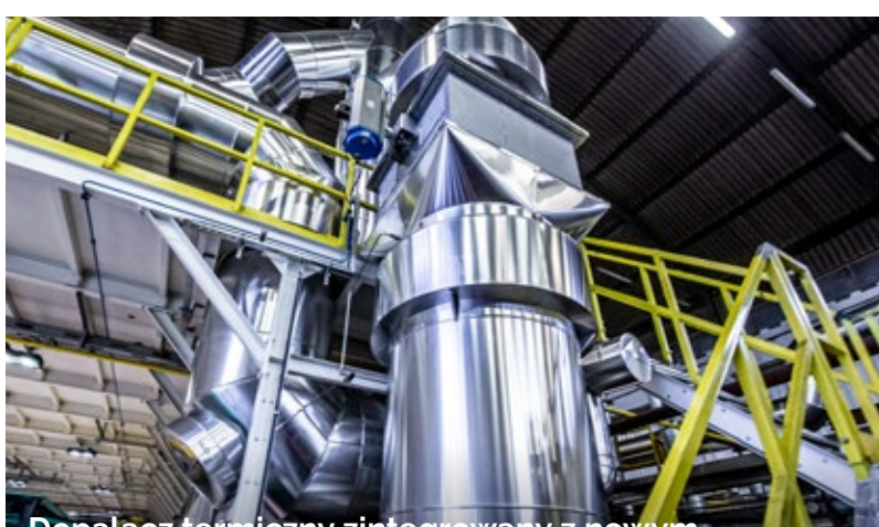
Dopalacz termiczny zintegrowany z nowym piecem do nawęglania
